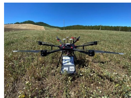
Fig. 3. The Matrice 600-Pro UAV (Arturo Argentieri, ISASI-CNR, pilot)
